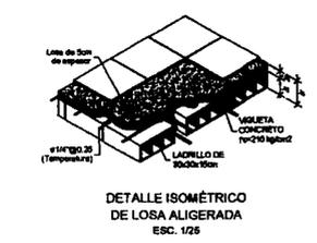
**DETALLE ISOMÉTRICO DE LOSA ALIGERADA**
